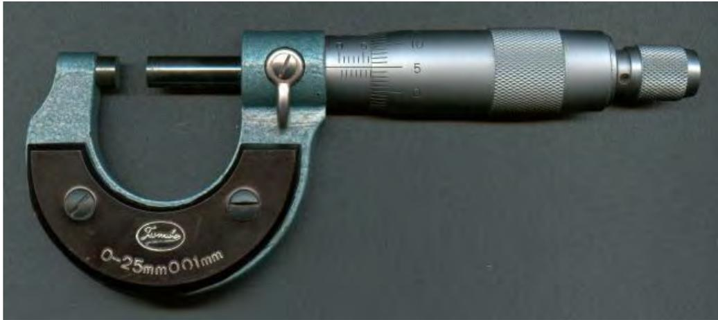
Una vite micrometrica è una vite<sup>42</sup> con filettatura di grande precisione e di grande qualità. Alla testa della vite è fissata una scala graduata. Se il passo della filettatura è di mezzo millimetro, e la scala graduata ha 50 divisioni, si ha la sensibilità di 0.01 mm.
