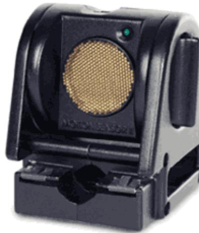
Un problema di questo sensore (con l'attuale software di acquisizione) è che le misure di distanza sono assegnate al tempo in cui vengono ricevuti gli impulsi riflessi, mentre le misure sono relative al tempo medio tra il tempo di trasmissione e il tempo di ricezione.
