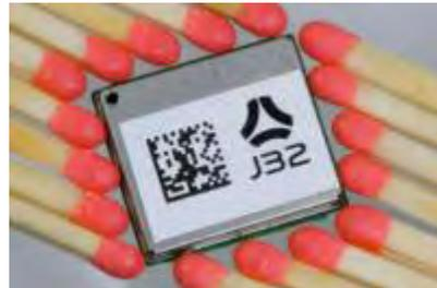
Tipico modulo per ricevitore GPS, basato sul chipset SiRF Star III, usato in molti prodotti.
