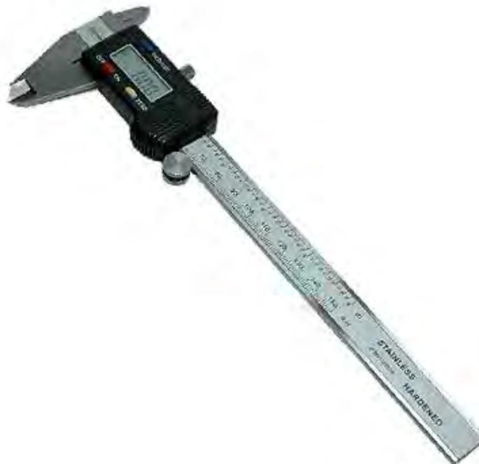
I calibri sono tarati per lavorare ottimalmente a 20 gradi. Per temperature differenti, per misure di grande accuratezza, va tenuto conto della dilatazione termica (vedi tavola in appendice).
