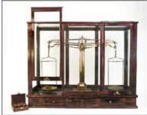
Questa bilancia di ottone, di 2 kg di portata, è conservata in una custodia di legno con cristalli, cassetti per gli accessori e due manopole di controllo per sbloccare e regolare la posizione dei piatti. La base della bilancia è dotata di livella e scala millimetrata. La struttura del giogo, di grande eleganza e funzionalità, è tale da consentire alta rigidità dei bracci e al tempo stesso la loro massima mobilità. Tre viti per lato regolano la posizione dei coltelli rispetto ai piatti.
